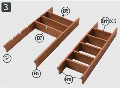
3 Sklej jak na zdjęciu-zwróć uwagę na położenie B7.
