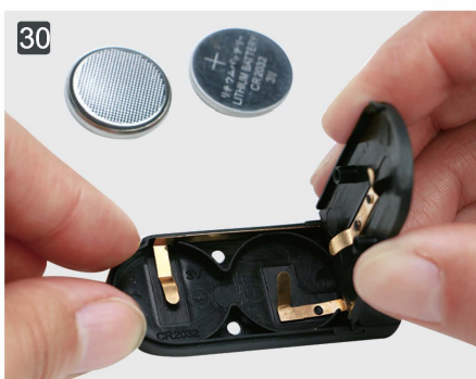
30 Umieść baterie w obudowie. (sprawdź położenie + i -)
