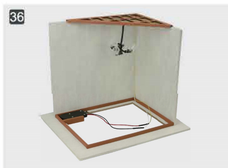
36 Umieść obudowę baterii na właściwym miejscu-włącznikiem do dołu. Nie klej na wypadek wymiany baterii.
