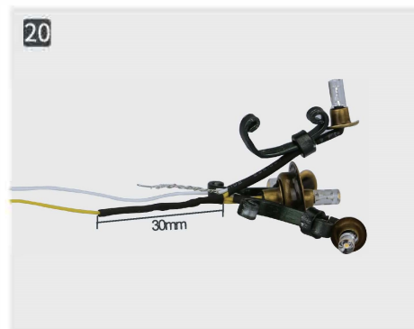
Przeciagnij kabel przez cieką rurkę termokurczliwą (30mm) i podgrzej (upewnij się, że żółty kabel jest dobrze zaizolowany)
