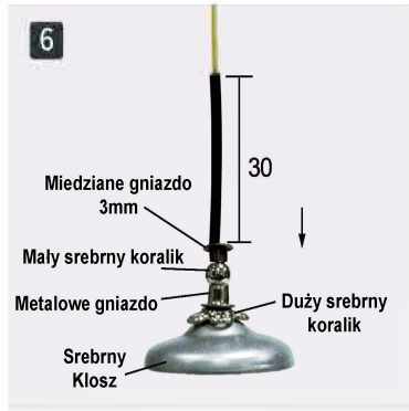
6 Przyklej w kolejności:klosz,duży koralik,met.gniazdo,mały koralik.Zgrzej rurkę term.(30mm).(nie klej miedzianego gniazda).
