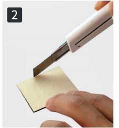
Przytnij miejsce łączenia drewna nożem.
