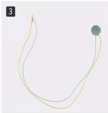
3 Wykonaj test po połączeniu przewodów(zwróć uwagę na + i -).
