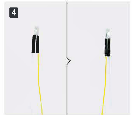
4 Utnij 2 szt. rurki termokurczliwej(6 mm) i umieść na przewodach. Ostrożnie zgrzej rurkę termokurczliwą zapalniczką.
