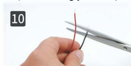
Usuń izolację z przewodów (12mm).
