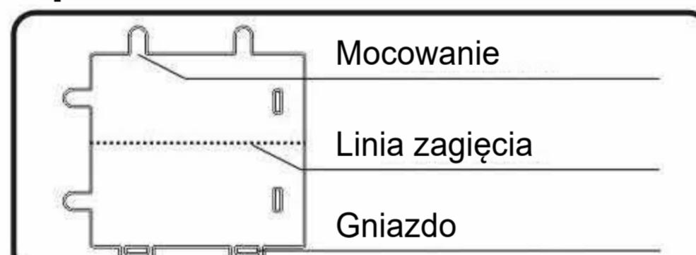
Zwróć uwagę na mocowanie, linię zagięcia oraz gniazdo podczas montażu elementów.
