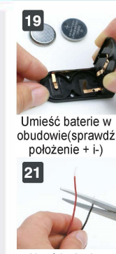
Usuń izolację z przewodów(12mm)
