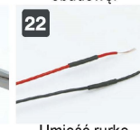
Umieść rurkę termokurczliwą na przewodach(20mm)
