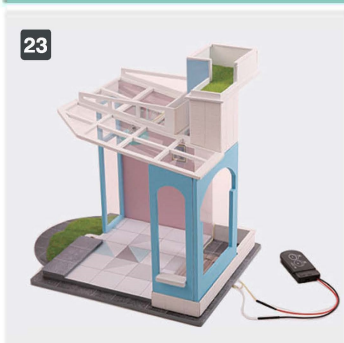
Połącz przewody lampy z przewodami obudowy baterii(żółty-czerwony, biały-czarny) Użyj zapalniczki, aby zaciśnąć rurki termokurczliwe.
