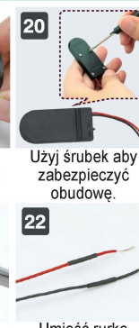
Umieść rurkę termokurczliwą na przewodach(20mm)
