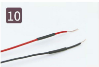
Utnij 2 szt. rurki term. (20mm) i umieść na przewodach.
