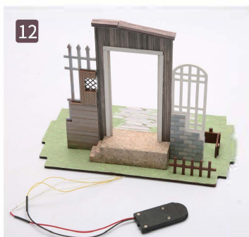
Połącz przewody lampy z obudową (żółty-czerwony, biały-czarny) Ostrożnie zgrzej rurki termokurczliwe.
