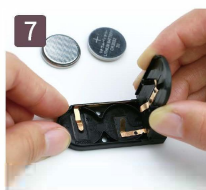
Umieść baterię w obudowie (zwróć uwagę na + i -)
