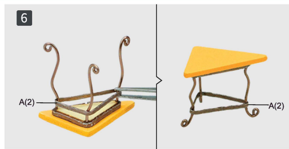
6 Przelóż B przez A(2) i zamocuj w otworach A9. Ustaw A(2) i przyklej jak pokazano.
